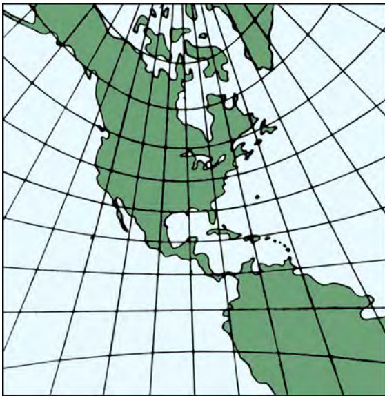
Figure 516b. An oblique gnomonic map with point of tangency at latitude 30°N, longitude 90°W.
